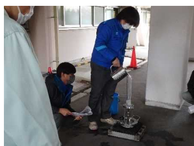
現場透水試験
