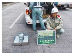
都市環境に配慮した道路舗装技術検討業務（遠熱性舗装 すべり抵抗値測定状況）
