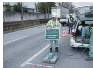
都市環境に配慮した道路舗装技術検討業務（遮熱性舗装 すべり抵抗値測定状況）
