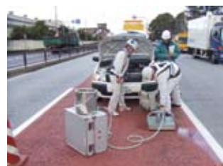
都市環境に配慮した道路舗装技術検討業務（遮熱性舗装 すべり抵抗値測定状況）
