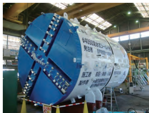
泥水式シールドマシン (外径 4.05m、長さ 6.10m)
