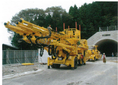
ドリルジャンボ（後ろは月岡トンネル）
