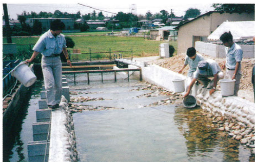
原寸大模型を用いた水理実験および遡上実験で良好な結果を得た
