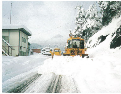
拡幅除雪作業
