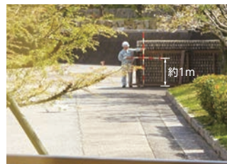
浄化センター浸水深（南門付近）
